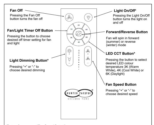
To turn fan on press "Fan Speed Button".
